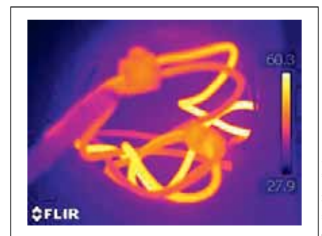
14 Thermografie der Verteilerdose mit Kupferleitungen in der Münchener Wohnung vor Ort
