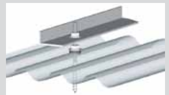
Wellfaserzement-Dach: Befestigung mit Stock- schrauben
