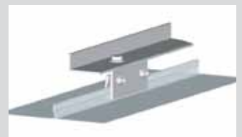
Blechfalz-Dach: Befestigung mit Falzdach-Klemmen für Rund- und Stehfalze
