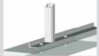
Tragfähige Oberflächen: Befestigung mit Schlagankern in Betonsteinen
