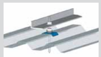
Trapezblech-Dach: Befestigung mit Stockschrauben
